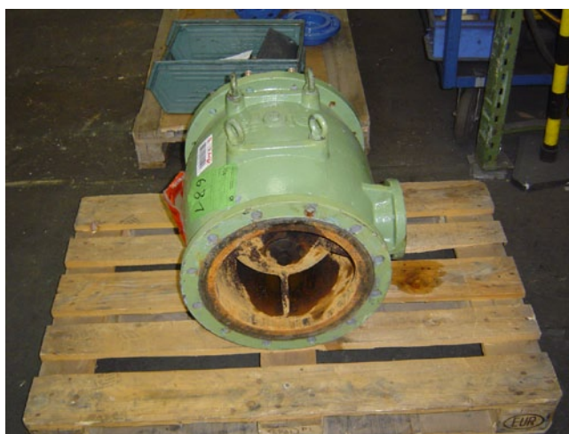
Плунжерный клапан, покрытый осадком от среды
