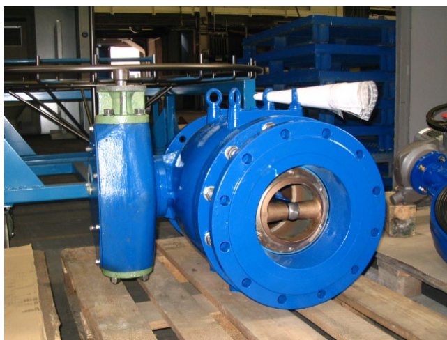
Плунжерный клапан после восстановления
