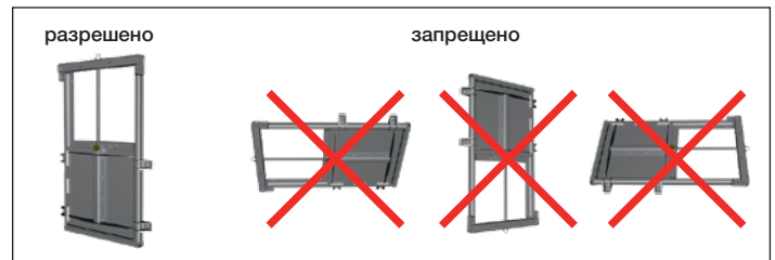
Рис. 6: Установочное положение щитового затвора VAG ERI@plus
