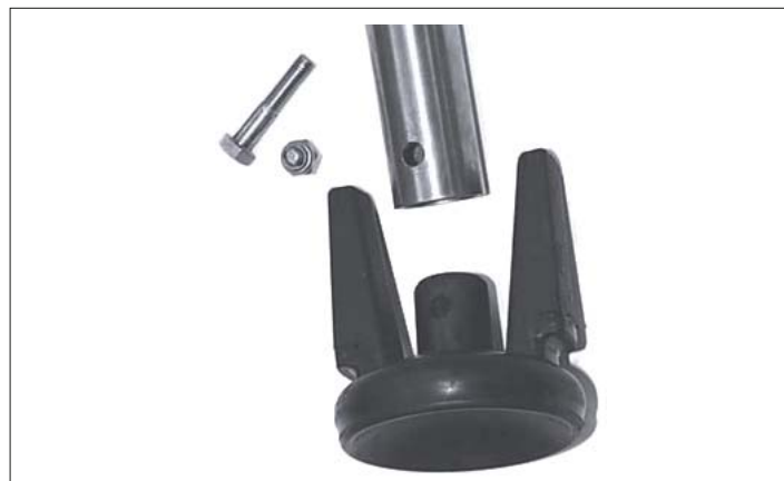
Obr. 10.: Dílce kuželky hydrantu - kuželka, trubka, šroub a samojistící matice
