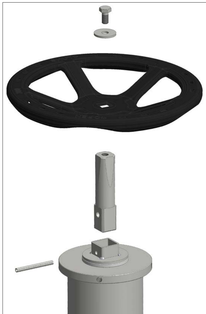
Obr. 4: Montáž ručního kola na sloupový stojan
