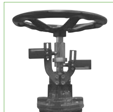
Ukazatel polohy s mechanickými spínači
