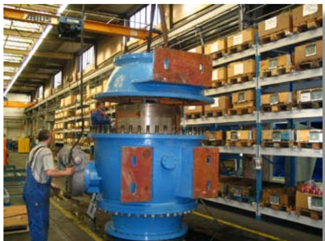
Vermessung der austauschbedürftigen Teile in der VAG-Servicewerkstatt
