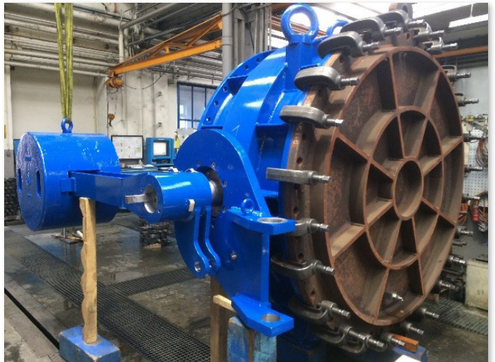
VAG Absperrklappe während der Druckprobe im Service-Center Mannheim
