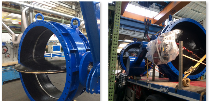
Absperrklappen nach der Komplettsanierung durch den VAG Technischen Service
