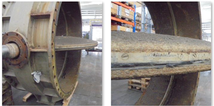
Anlieferungszustand der beiden AKL Absperrklappen aus dem Jahr 1971
