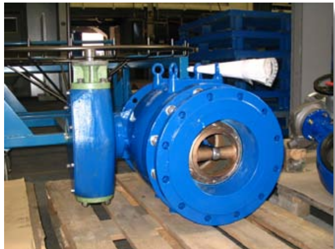
Válvula de paso anular luego del saneamiento
