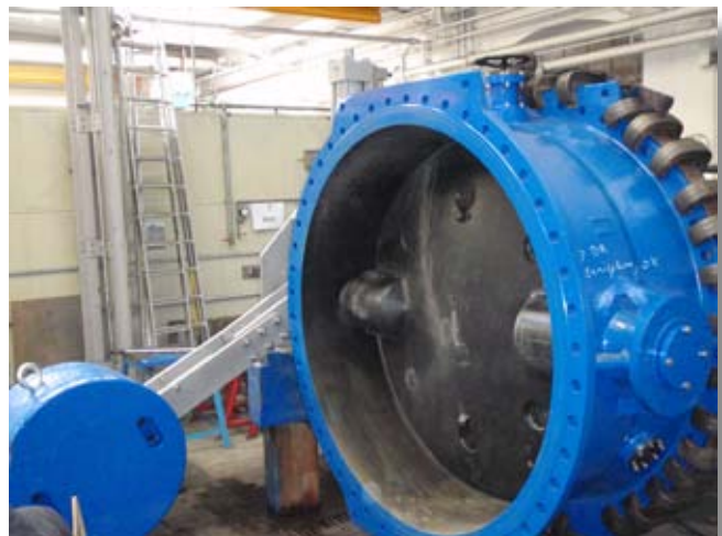
Válvula de mariposa VAG EKN® con accionamiento de contrapeso hidráulico en la entrega al cliente para la prueba de presión en el año 2009
