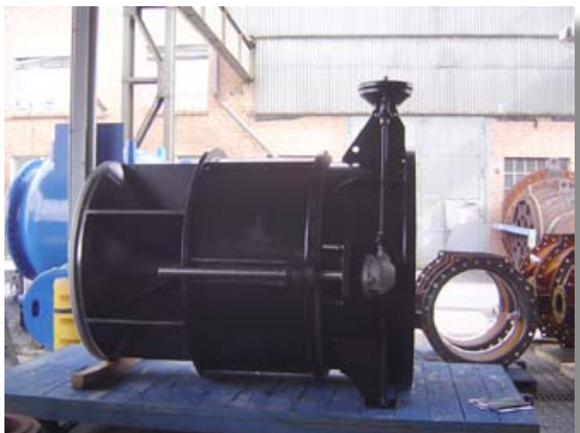
Válvula de descarga de fondo VAG KSS luego del saneamiento
