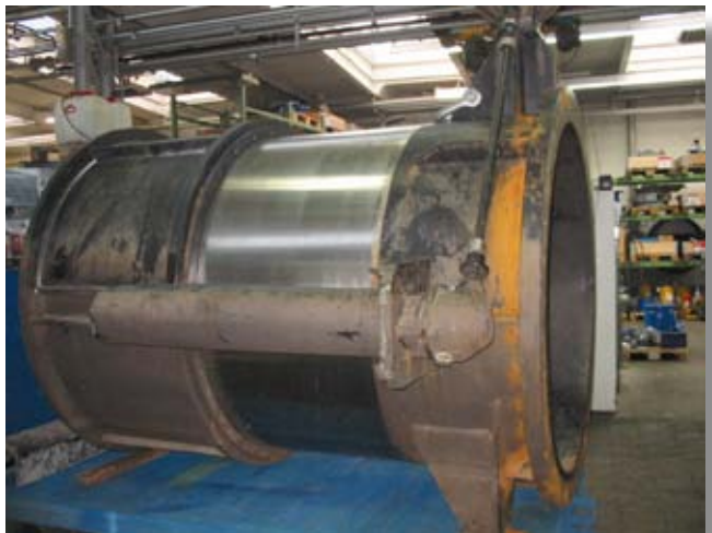
Desmontaje de la válvula de descarga de fondo VAG KSS de 10 años de antigüedad
