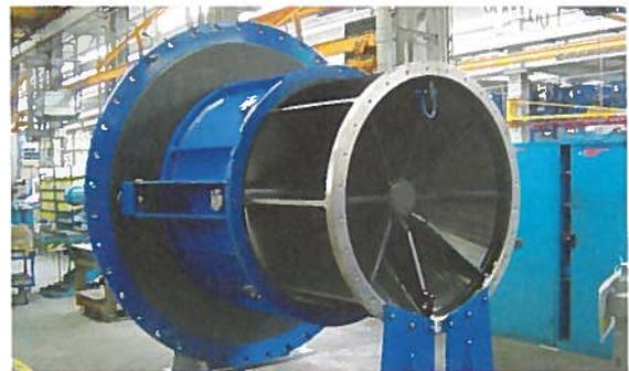
**Bild 4:** VAG KSS Kegelstrahlschieber DN 1 600 PN 25 vor seiner Auslieferung nach Asahan
